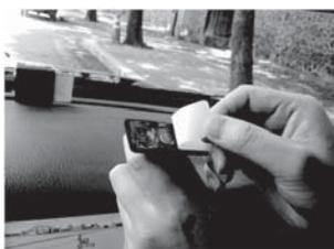
取付けステーの接着テープ保護フィルムを剥がして下さい。
