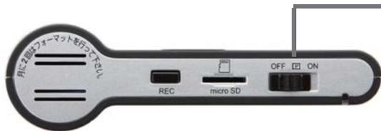
本体の後面にあるスイッチは駐車監視機能をON/OFFするためのスイッチです。このスイッチをOFFにすると駐車監視機能がOFFになります。駐車監視機能を使用する場合は車のエンジンがかかっている状態で駐車監視スイッチをONにしてください。
