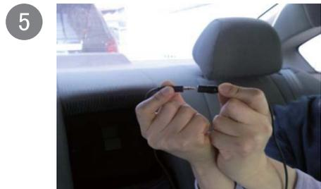
後方カメラと延長ケーブルを接続します。
