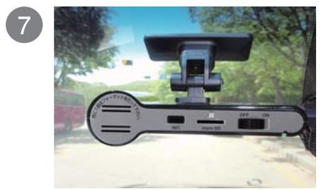
電源ケーブル端子をDCポートに接続し、電源スイッチをONにしてください。(レンズ保護用フィルムを剥がして下さい。)
