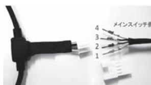
電源ケーブルと駐車監視スイッチは4ピンコネクタで接続します。スイッチ側のコンタクトピンは、配線の作業効率を上げるため、コネクタに差し込まれていません。
