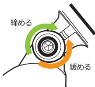
常時録画開始を確認し、タッチパネル画面を見ながら撮影角度を調節し六角レンチでブラケットの固定ねじを締めてください。ねじの締めすぎにご注意ください。
