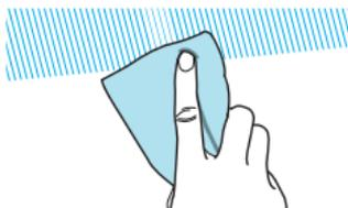
本体を装着する位置のフロントガラス、後方カメラを装着する位置のリアガラスの脱脂作業を行います。
